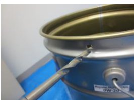
Φ6mmドリルで穴明け4か所に穴をあける。 注)バリがあるので注意
