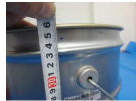
同様に全周に4か所バランスよく十字に缶の底から348mmのところマークする。
